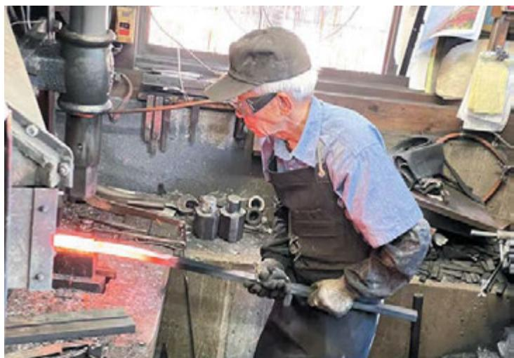
写真では、分かりづらいですが、片刃の場合はハガネを合わせて打ち付けるのですが、両刃の場合は挟み込むように打ち出します。この写真は、翌日訪問した鍛冶屋さんでの打ち出し風景です。
